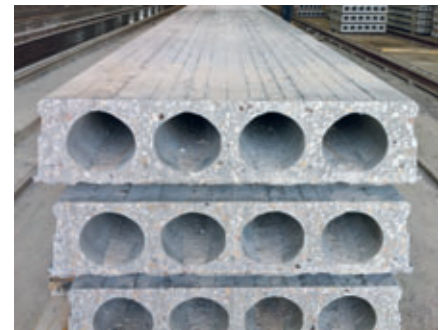
Dalle alvéolée d'une largeur de 900 mm produite avec une extrudeuse Nordimpianti.
