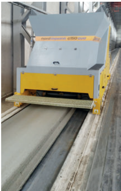
Extrudeuse lors du coulage d'une dalle alvéolée étroite de 900 mm de largeur, sur un banc de production standard de 1 500 mm.
