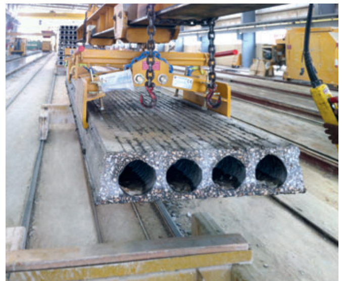
Levage d'une dalle alvéolée de 900 mm avec les pinces ad hoc.
