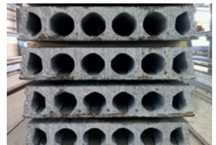
Dalle alvéolée d'une largeur de 1 100 mm produite avec une extrudeuse Nordimpianti.
