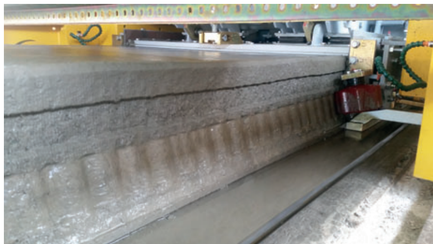
Détail du rail latéral profilé innovant développé par Nordimpianti.
