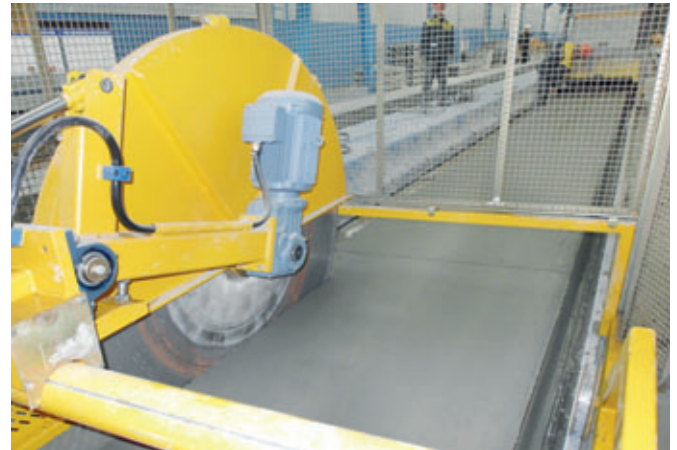
Découpe longitudinale d'une dalle alvéolée en béton fraîchement coulée, à l'aide de la scie pour béton frais Nordimpianti.
